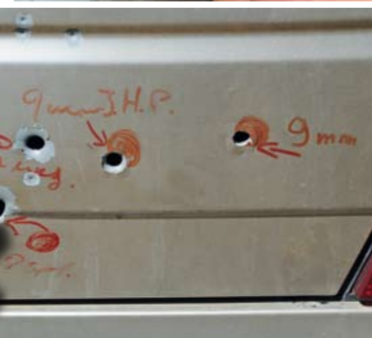
Oben: Wirkungsweise unterschiedlicher Flintenmunition auf die Karosserie eines Fahrzeuges. Nicht jede Art ist immer besonders Wirkungsvoll. Manche ist jedoch fatal.
